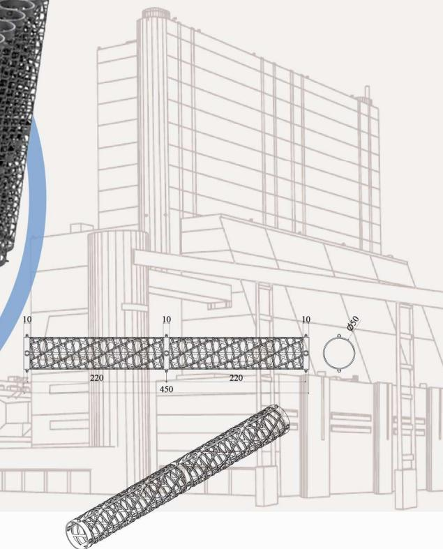
به افزایش راندمان برج خنک کننده می شود. این فیلینگ با موقیت در صنایع مختلف استفاده شده است. انتقال حرارت و جرم عالی دو مشخصه مهم این فیلینگ است. با توجه به طراحی ویژه این محصول خنک کاری مؤثر با افت فشار کم قابل دستیابی است.
